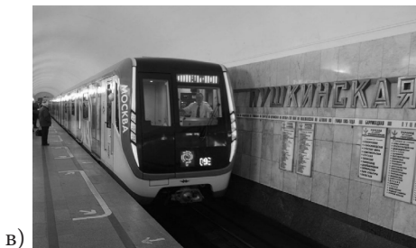
Рис. 4.2. Низкопольный подвижной состав: а) трамвай; б) автобус; в) поезд метрополитена
