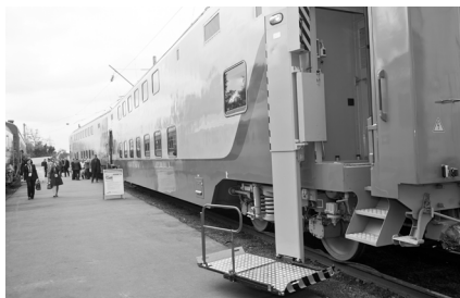
Рис. 4.3. Приспособления для плавного преодоления зазора и(или) перепада высот между порогом двери транспортного средства и посадочной площадкой или перроном
