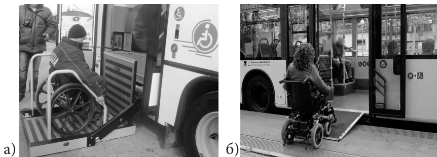
Рис. 7.15. Примеры обустройства автобусов подъемником (а) и аппарелью (б)
