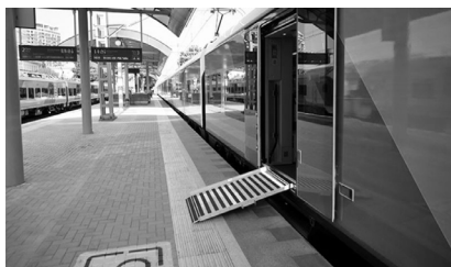
Рис. 7.34. Раскладной переносной пандус на МЦК Московский метрополитен. Находится на борту транспортных средств подвижного пассажирского состава
