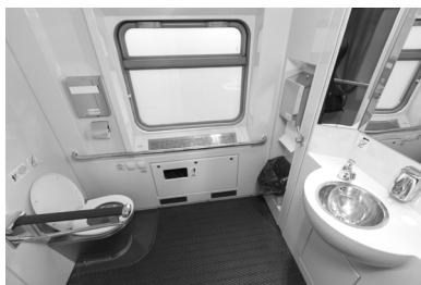
Рис. 7.3. Оборудование санитарно-гигиенического помещения
