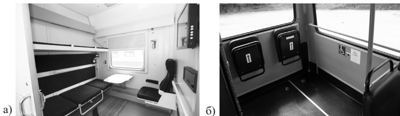
Рис. 4.5. Примеры специально оборудованных мест в транспортных средствах для размещения пассажиров на кресле-коляске: а) пассажирский вагон; б) автобус
