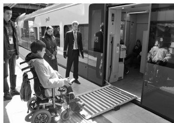
Рис. 7.34. Раскладной переносной пандус на МЦК Московский метрополитен. Находится на борту транспортных средств подвижного пассажирского состава
