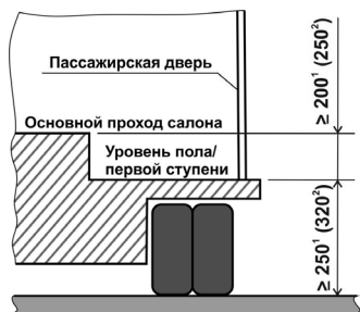
Рис. 7.16. Параметры высоты пола и ступеней транспортных средств
