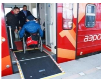
Рисунок 38 – Приспособления для преодоления зазора и (или) перепада высот между порогом двери транспортного средства и посадочной площадкой или перроном
