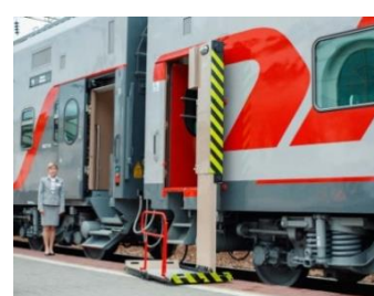
Рисунок 38 – Приспособления для преодоления зазора и (или) перепада высот между порогом двери транспортного средства и посадочной площадкой или перроном
