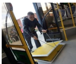
Рисунок 38 – Приспособления для преодоления зазора и (или) перепада высот между порогом двери транспортного средства и посадочной площадкой или перроном
